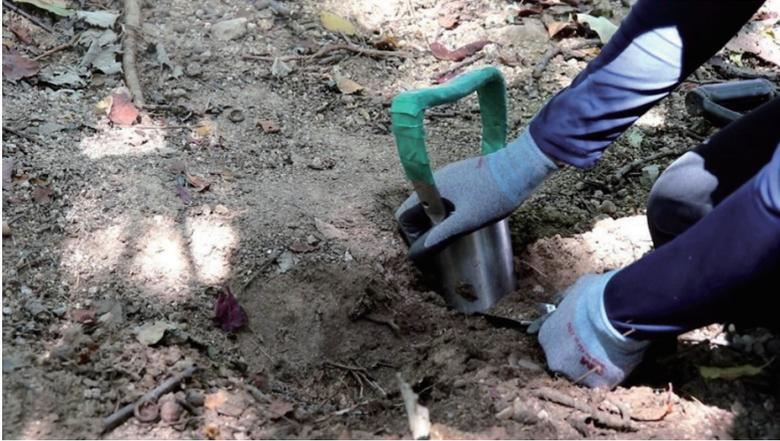
그림 14 토양 코어를 이용한 토양 채취
