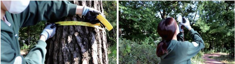
그림 11 흉고직경(좌) 및 수고 측정(우)
